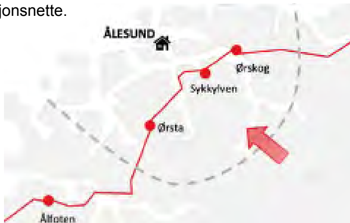
Transmisjonsnettet på Sunnmøre Nettet har ein importbegrensning på 850 MW
